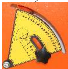
Scala di profondità regolabile in base al diametro del disco montato
