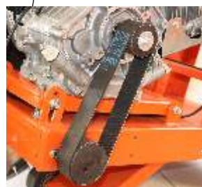
Cinghia di trasmissione del disco più larga
