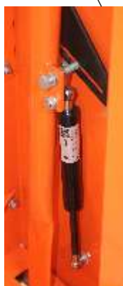
Molla a gas per abbassare / sollevare il disco più facilmente
